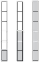
L'indicazione del livello di avanzamento fornisce informazioni sull'avanzamento del programma. Più LED arancioni sono accesi, minore è il tempo residuo. Alla fine del programma, tutti i 6 LED arancioni sono accesi.
